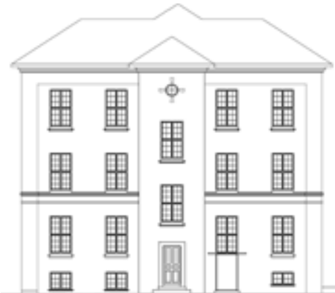
Fig.41. Baldakinen over elevatordøren på Sønderhus' nordfacade må skiftes ud med en baldakin med samme udformning. Også selve elevatordøren må skiftes ud. Ved udskiftning skal døren have samme udformning som Sønderhus' oprindelige adgangsdøre i henhold til de overordnede bestemmelser.
