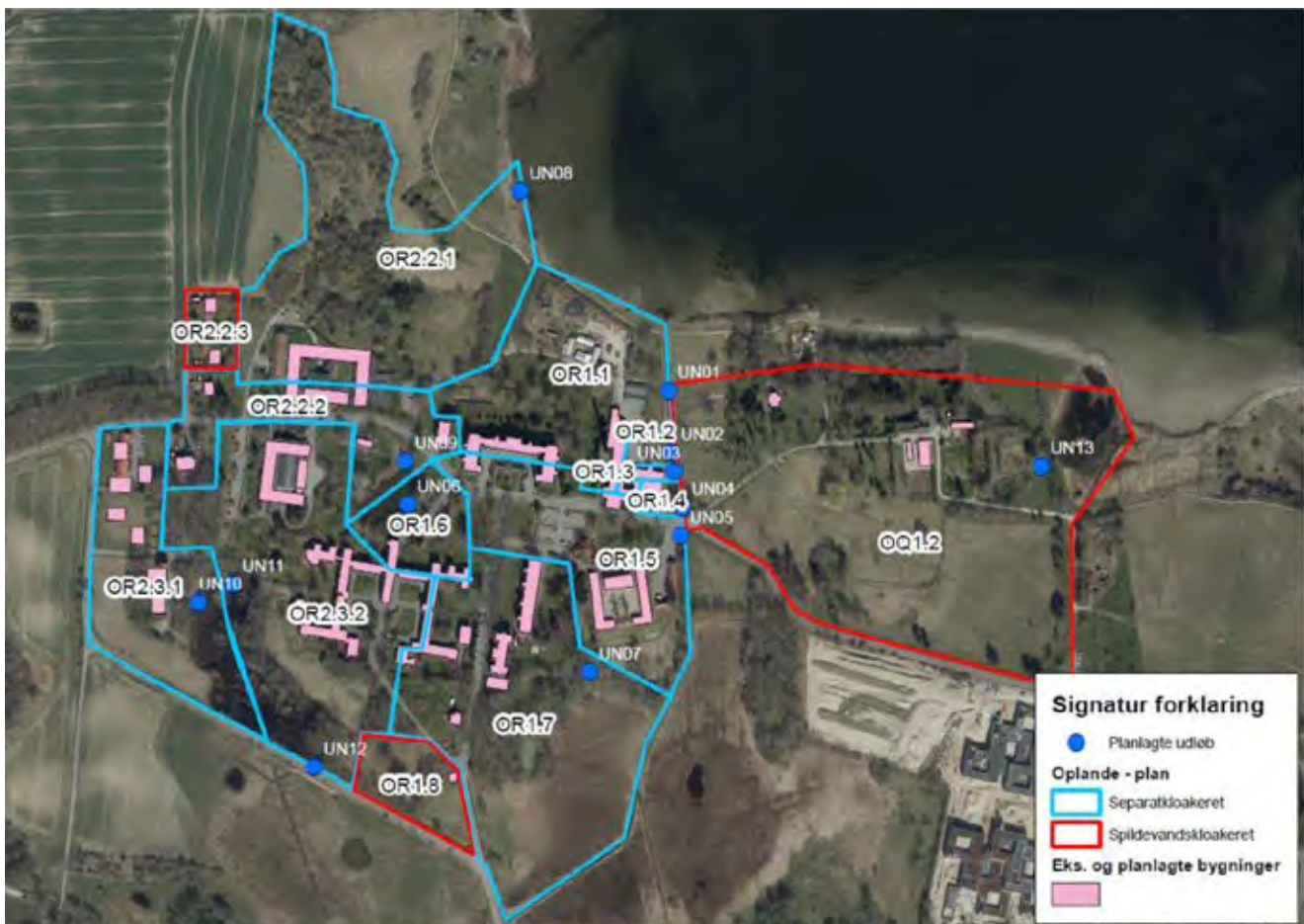
Fig.40. Kort fra tillæg nr. 12 til Spildevandsplan 2015-2021 som viser indeling af kloakoplande og placering af udløb på Sankt Hans
